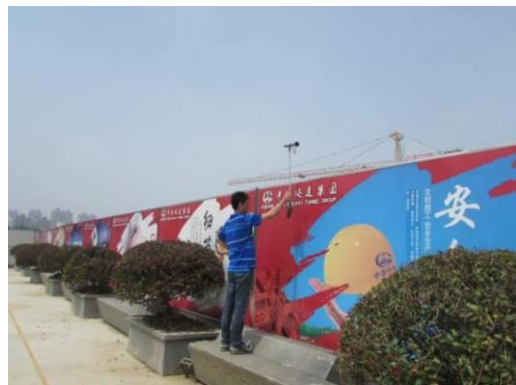
施工期噪声监测
